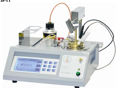
На основании положительных результатов межлабораторных сравнительных испытаний аппарат ТВЗ-ЛАБ-11 рекомендован техническим комитетом по стандартизации ТК-31 к применению для контроля качества нефтепродуктов по процедуре ГОСТ 6357, ГОСТ Р ЕН ИСО 2719, ASTM D93 по показателю "температура вспышки в закрытом тигле".
