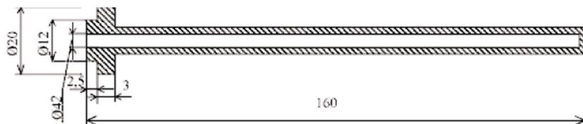
Рис.Б.1 Трубка металлическая
