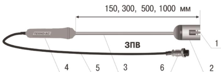
Рис А1 Зонд поверхностный (ЗПВ.8, ЗПВТ.8)
