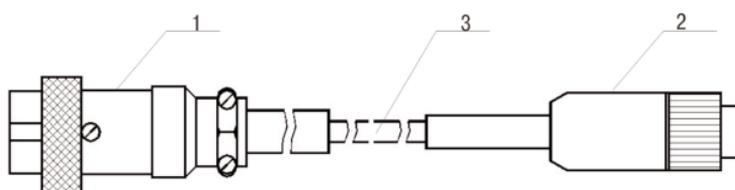
Рис.Б.2 Кабель удлинительный для ЗВЛМ
