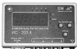
Приборы предназначены для измерения температуры, влажности, давления, уровня жидкости, силы тока, напряжения, мощности; регистрации и хранения результатов в памяти прибора с последующей их передачей на компьютер для визуализации в виде графиков и таблиц.
