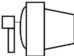
Входное окно фотоприемников должны быть обращено по направлению к плоскости экрана, при этом диаметр измеряемой площадки не превышает (7...9) мм.
