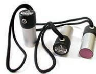
Преобразователями с жидкостным контактом для сквозного прозвучивания:
