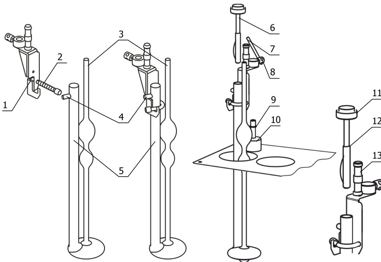
Рисунок 5 — Установка вискозиметров
