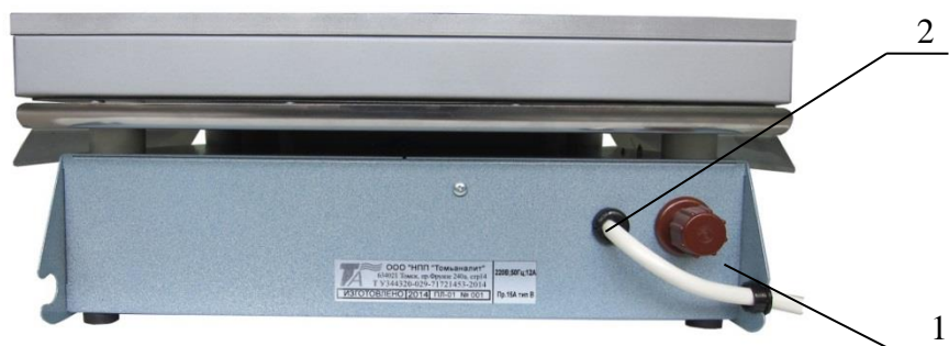
Рисунок 2 – Плита нагревательная лабораторная ПЛ-01 (вид сзади)
